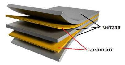
Рис. 1 Общая схема гибридного металлополимерного материала
