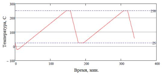
Рис. 10 Температурная программа ДСК сканирования на скорости 2°С/мин
