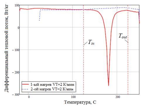
Рис. 11 Термограммы первого и второго нагрева композита
