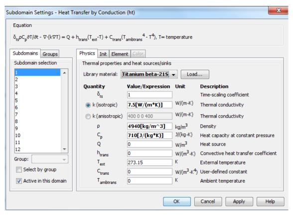
Рис. 13 Задание физичесчких и теплофизических свойств каждого слоя композита
