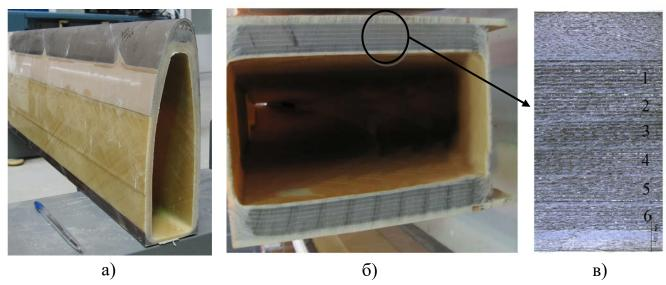
Рис. 4 Лонжерон лопасти несущего винта вертолета Ми-28: а) сечение носовой части лонжерона ЛНВ, б) комлевое сечение лонжерона ЛНВ
