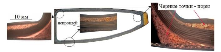
Рис. 5 Дефекты формования лонжерона
