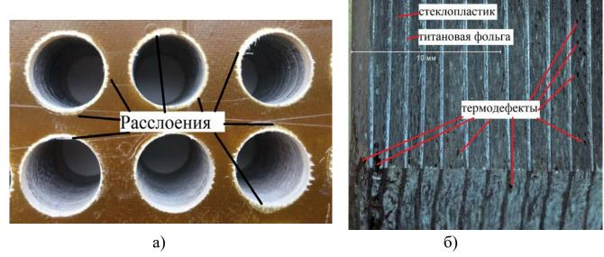
Рис. 7 Дефекты механической обработки посадочных отверстий в лонжероне ЛНВ: а) расслоения в местах выхода сверла, б) термодеструкция и нарушение адгезии слоев ПКМ и титана под действием перегрева
