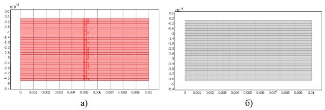
Рис. 12 Математическая модель композита стеклопластик-титан: а) геометрическое описание, б) конечно-элементная сетка
