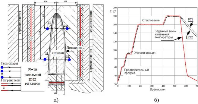
Рис. 6 Формование лонжерона ЛНВ в пресс-форме: а) секция пресс-формы, б) температурный цикл нагрева и отверждения [6]
