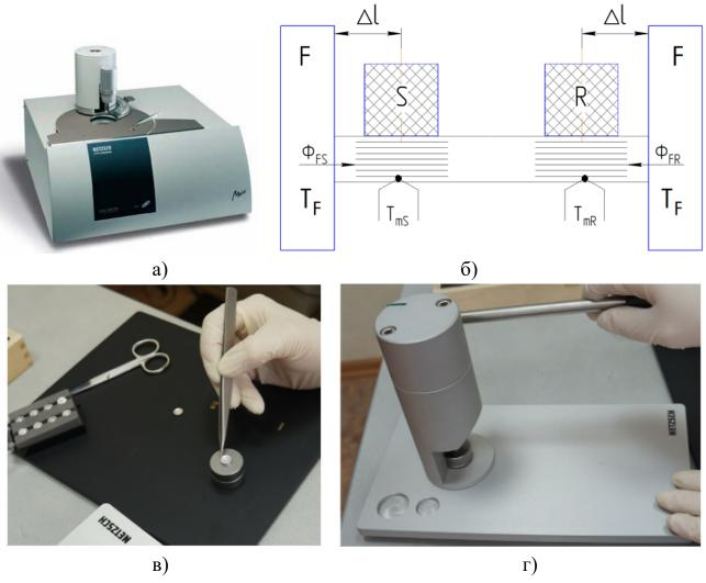
Рис. 9 Дифференциальный сканирующий калориметр DSC 200 F3 Maia: a) общий вид, б) схема работы, в) подготовка образцов для помещения в контейнер, в) запрессовка контейнера
