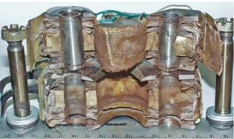
Рис. 8 Усталостное разрушение рулевого винта по перемычкам отверстий комлевого стыка
