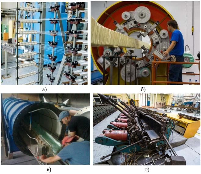
Рис. 3 Изготовления лонжерона ЛНВ вертолета Ми-28: а) получение препрега, б) напотка стеклолент на оправку, в) загрузка лонжерона в автоклав, г) пресс-форма для окончательного отверждения лонжерона
