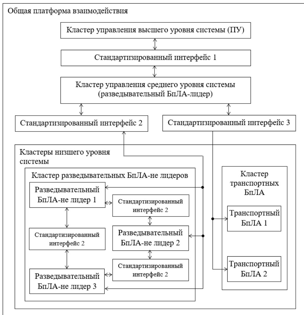
Рисунок 5 – Архитектура организации взаимодействия бортовых программных систем БпЛА в группе и с ПУ в условиях нестабильного информационного обмена
