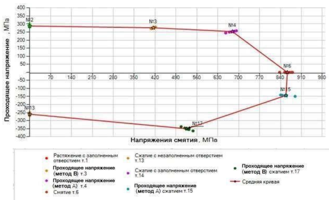
Рисунок 7 - Диаграмма при совместном действии сминающей и проходящей нагрузки с учётом типа соединения
