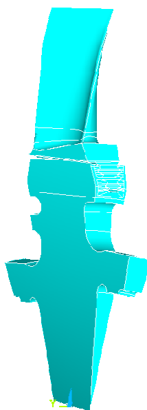
Рис. 5. Расчетная модель для прочностного анализа рабочего колеса турбины турбокомпрессора ТК-32
