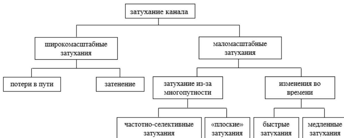
Рис. 1. Схема классификации затуханий сигнала
